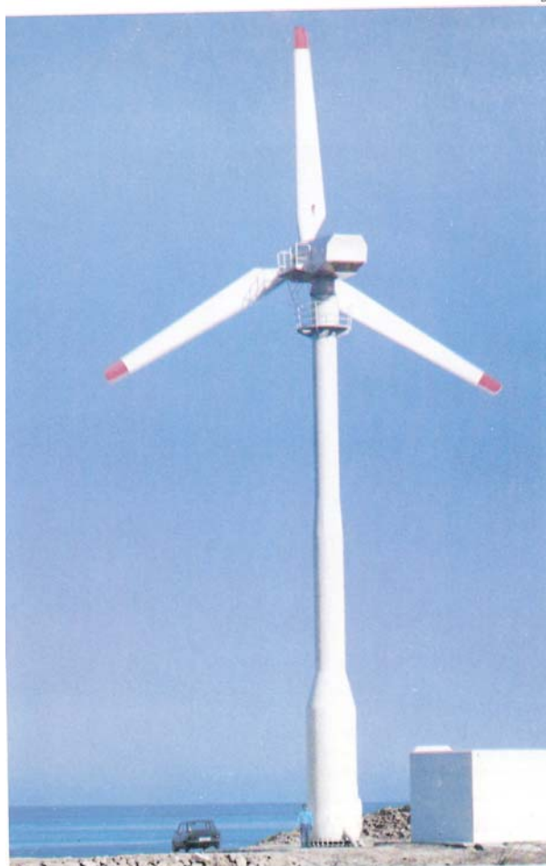
Φωτογραφία 11β: Ανεμοκινητήρας ονομαστικής ισχύος 150 KW (μεταβλητών σφρών), ελληνικής σχεδίασης και κατασκευής (Εργαστήριο Αεροδυναμικής Ε.Μ.Ι)
